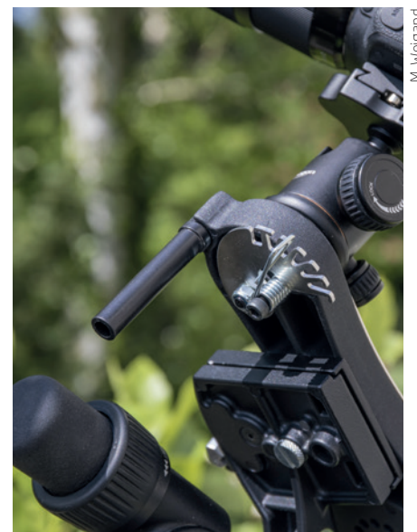
▲ Abb. 2: Die Polsucher-Peilhilfe und die mehrstufige Federkonstruktion zum Ausgleich von Ungleichgewichten.
